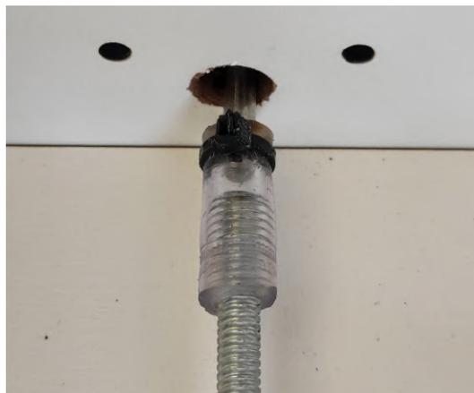
Figura 7. Conexão do motor com o eixo (Autores)
