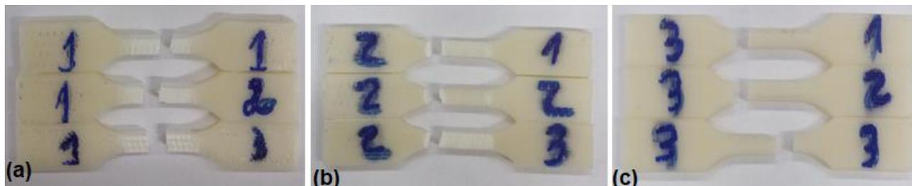
Figura 6 - Corpos de prova após o ensaio de tração. (a) CP1, (b) CP2 e (c) CP3
