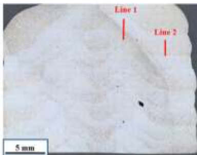
Figura 7. Seção transversal típica de paredes de aço inoxidável duplex tipo 2205 depositadas em DED-Arco GMA. A área mais clara contém mais austenita e a mais escura mais ferrita. Um padrão pode ser visto na amostra depositada, onde as linhas 1 e 2 representam as regiões gravadas mais claras e mais escuras, respectivamente (Hosseini et al. , 2020).
