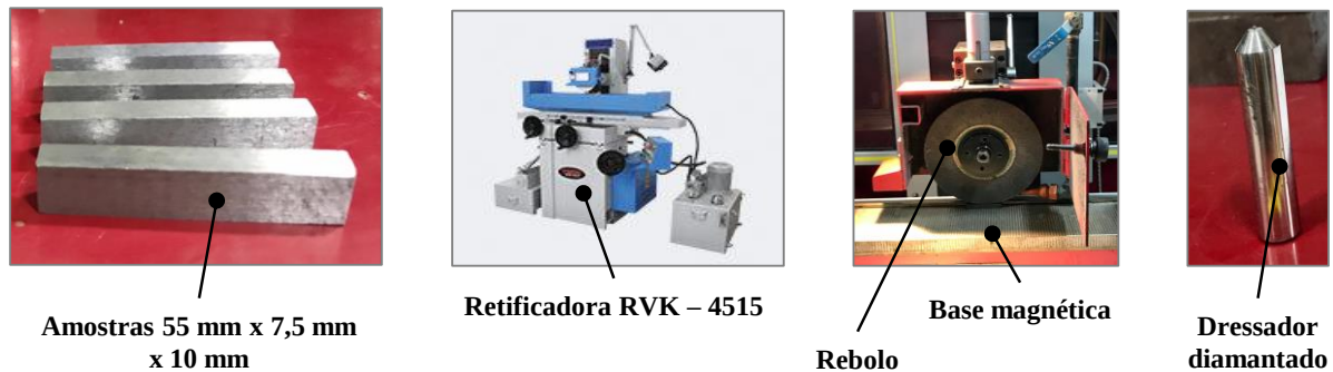
Figura 1. Amostras em aço ABNT 1045, retificadora Benner RVK-4515, rebolo de Al_2O_3 e dressador
