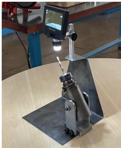
Figura 5. Conjunto utilizado para a medição do desgaste da broca.
