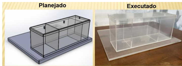
Figura 5: Reservatório em acrílico transparente de 4 mm com base de 10 mm. Fonte: O autor (2021).
