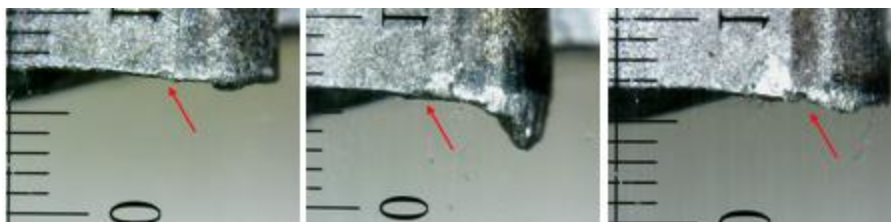
Figura 4. Caracterização do fim de vida da ferramenta pelo surgimento de entalhe quando utilizada v_c = 150 m/min, nas condições de lubrificação a seco (esquerda), MQL (centro) e jorro (direita)
