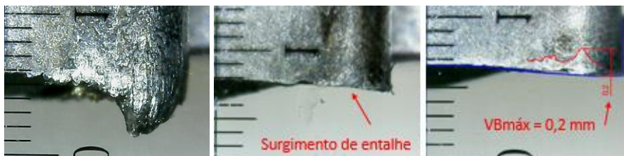
Figura 3. Ensaios com v_c = 90 m/min: material aderido na ferramenta na usinagem a seco (esquerda); caracterização do fim de vida da ferramenta para torneamento com MQL (centro) e com fluido em abundância (direita)
