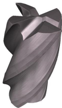
Figura 3. Caracterização de uma fresa de topo reto utilizando o ALICONA®
