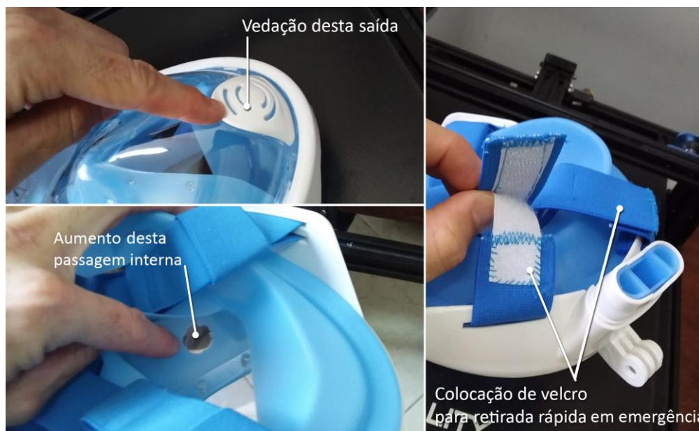
Figura 4. Adaptações feitas na máscara de mergulho preparando para uso em VNI em aplicação de saúde, (Autor).
