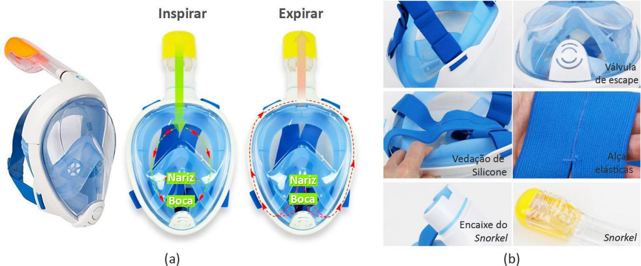
Figura 2. Máscaras de mergulho do tipo Snorkel Easy breath , em (a) fluxo de ar, em (b) detalhe dos componentes que à compõe. Fonte: Adaptado de Wish (2021)
