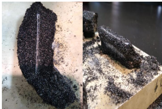
Figura 4: Canal formado na face superior da agregado (esquerda) e poça maciça no interior do agregado (direita)
