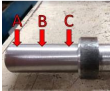
Figura 1 – Detalhamento das réplicas de ensaio para as condições experimentais (1) com (2) sem lubrificação (Autores, 2021)
