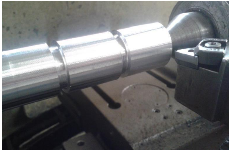
Figura 1. Preparação da barra de aço SAE 4340 para a realização dos ensaios.
