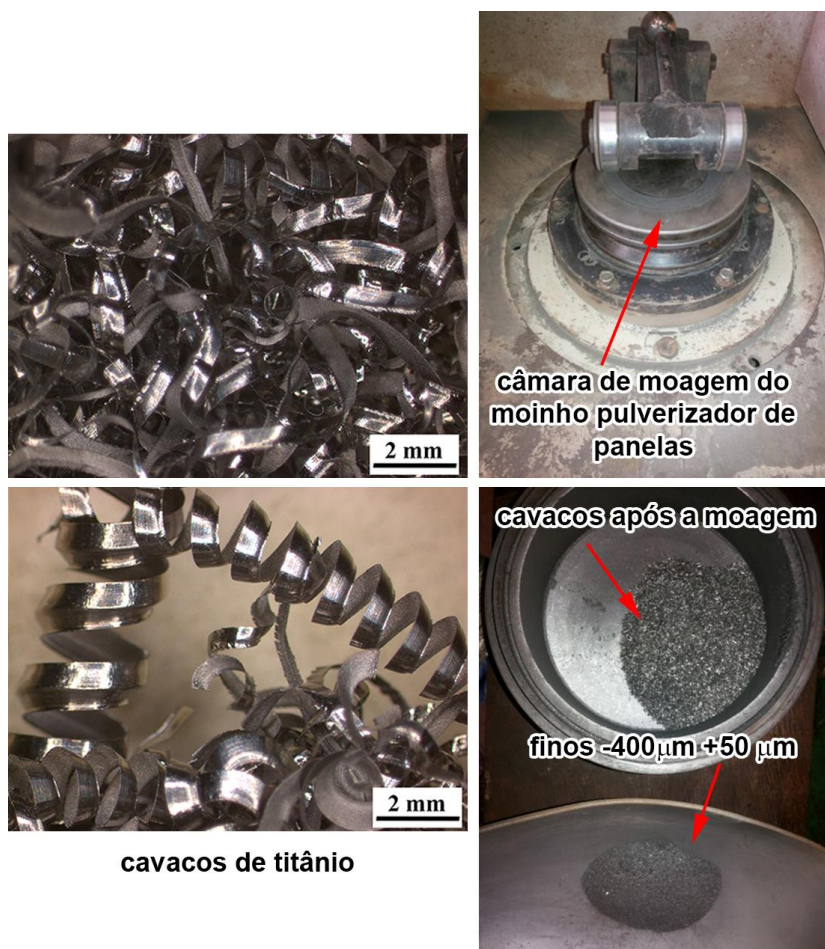
Figura 1 – Aspectos dos cavacos de titânio desde o aspecto recebido, durante e após a moagem.
