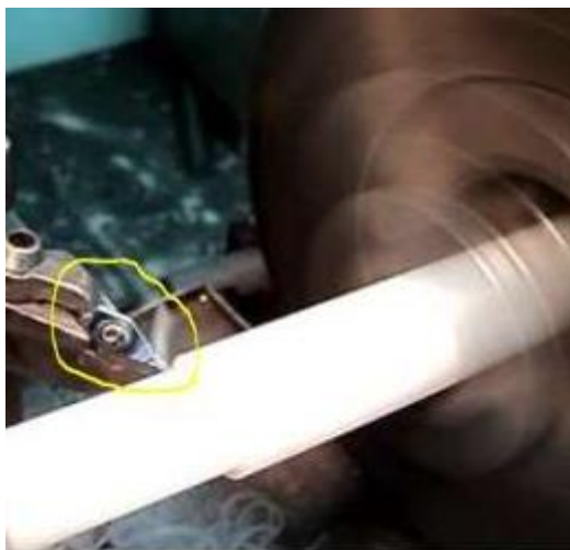
Figura 8. Ferramenta com o correto ângulo de posição para a usinagem de plásticos
