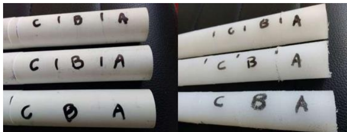
Figura 7 Aspecto visual do acabamento após a usinagem dos corpos de prova de: (esquerda) PVC, (direita) nylon
