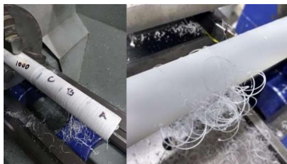
Figura 6. (esquerda) Formação de cavacos, (direita) Cavacos presos à peça quando utilizada a rotação de 1.000 min -1 e o avanço (f) de 0,28 mm/rev.
