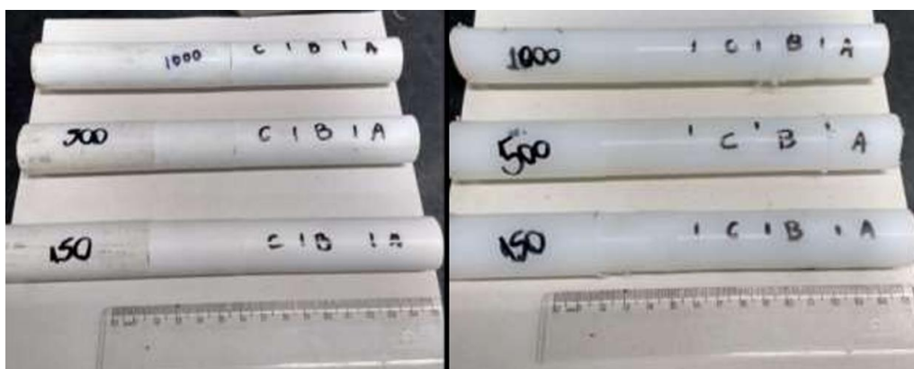
Figura 5. Corpos de prova com a definição das regiões para usinagem: (esquerda) PVC, (direita) nylon
