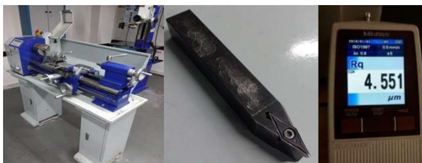
Figura 3. Equipamentos utilizados: (esquerda) Torno de bancada Manrod MR – 334, (centro) ferramenta e porta-ferramentas utilizadas, (direita) rugosímetro Mitutoyo SJ-210
