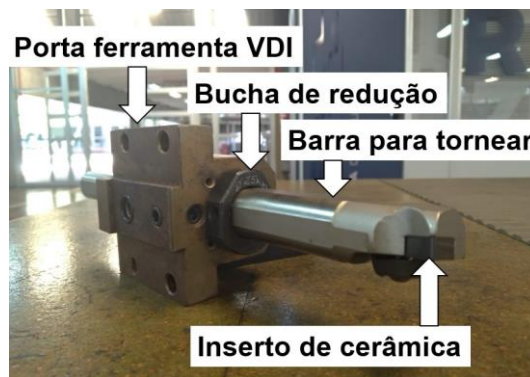
Figura 3. Esquema de acoplamento da ferramenta na torre da máquina
