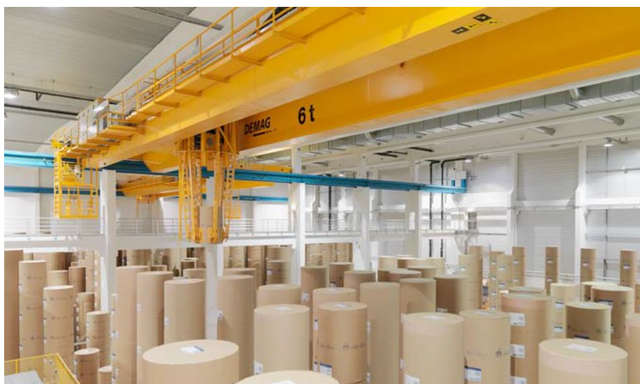
Figura 3. Sistema de coleta das bobinas por ponte rolante na Palm Paper em King's Lynn, UK (Demag, 2018)
