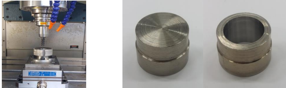
Figura 2. Setup experimental, corpo de prova e corpo de prova usinado do aço inoxidável super duplex UNS S32760
