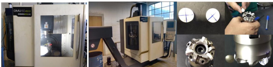
Figura 2 – Centro de Usinagem e suporte de fixação dos insertos
