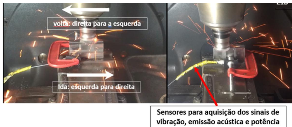
Figura 4 - Fixação do corpo de prova e percurso da ferramenta e fixação e posição dos sensores
