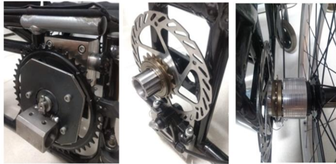
Figura 8. Conjunto Dianteiro, Traseiro e fixação na roda, respectivamente (Próprio Autor, 2020)
