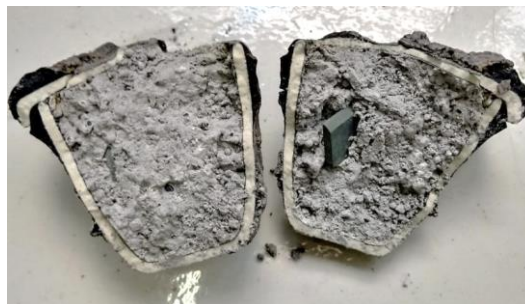
Figura 3. Fotografia do cadinho menor aberto após processamento dos revestimentos por Double pack cementation. A pack mistura do cadinho maior depositou-se na superfície do cadinho menor. (As autoras, 2021)
