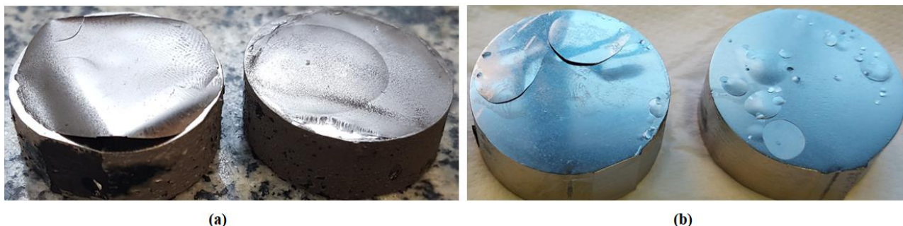
Figura 2 – Amostras após a deposição de NiP com pré tratamento superficial de (a) apenas polimento e (b) polimento e ataque com o reagente Keller (Autoria Própria)
