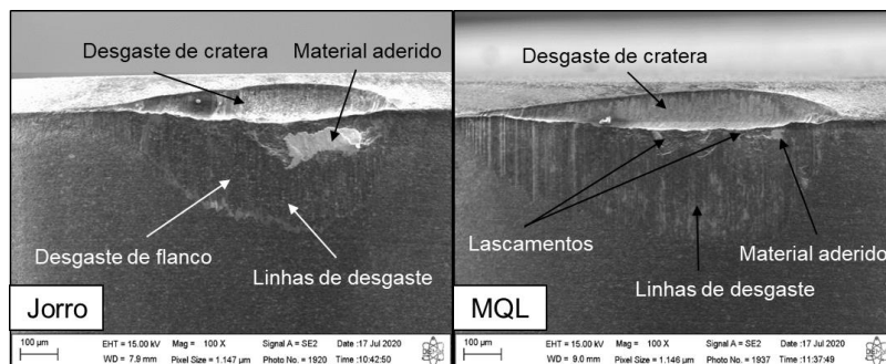
Figura 4. Imagens obtidas por MEV das arestas desgastadas sob as diferentes condições de lubrificação estudadas.
