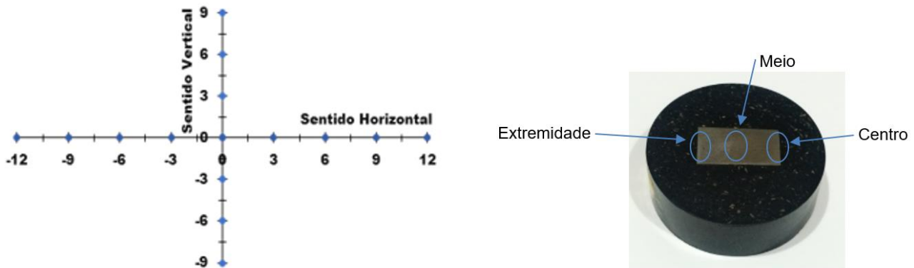
Figura 2. Metodologia adotada a) Divisão de pontos utilizados na medição de dureza das amostras; b) Amostra embutida para metalografia. (Autoria própria)
