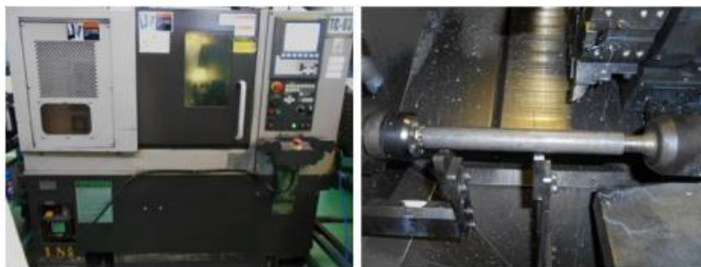
Figura 1. Torno CNC utilizado (à esquerda) e detalhe da fixação da peça e ferramenta de corte (à direita).
