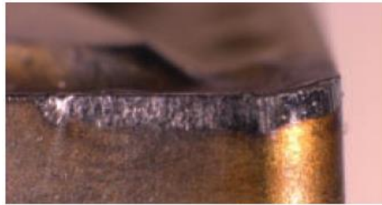
Figura 1. “Desgaste de flanco” na aresta de corte de uma pastilha intercambiável de metal-duro utilizada no “Processo de Usinagem por Fresamento”.
