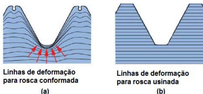
Figura 1. Diferenças entre os perfis de roscas usinadas e conformadas (Emuge, 2010)
