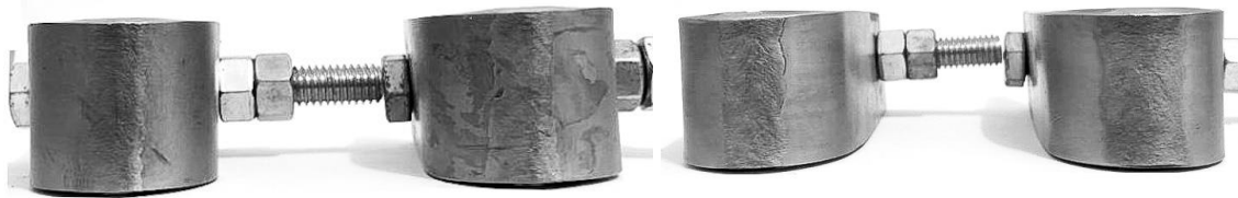
Figura 6. Corpos de prova após ensaios de dobramento: à esquerda, juntas BA, direita, juntas AA.
