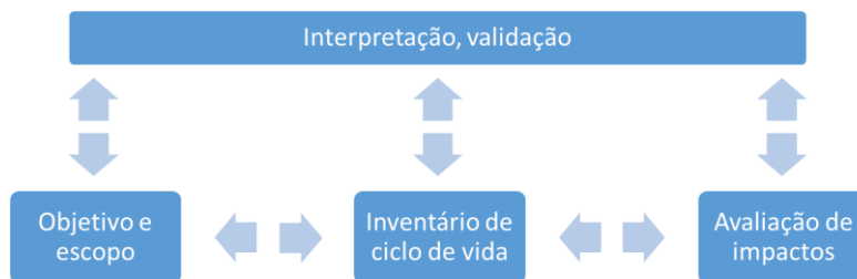
Figura 1. Esquema das etapas da avaliação de ciclo de vida segundo a norma ISO 14040.
