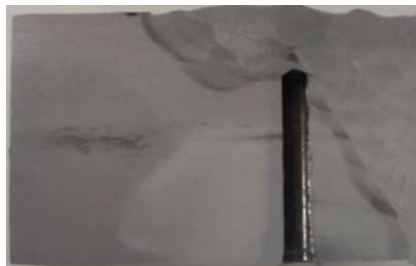
Figura 4- Croqui e macro (antes da goivagem) do posicionamento do furo do termopar. Ilustração: Autor
