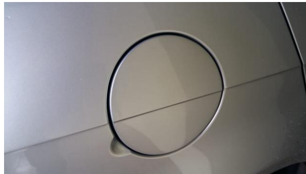
Figura A3. “Portinhola de Acesso à Tampa do Bocal do Tanque de Combustível”.
