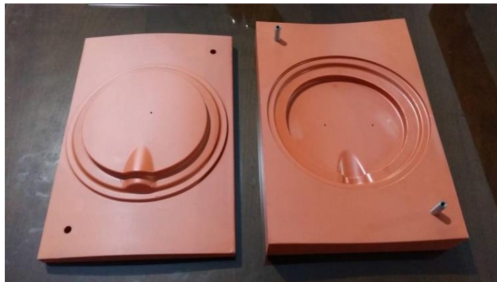
Figura 6. “Punção” e “Matriz” usinados em NECURON® 1300.
