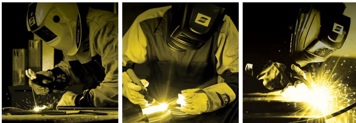
Figura 1. Os mais usados processos de soldagem a arco: soldagem por eletrodo revestido (à esquerda), soldagem TIG/GTAW (no centro) e soldagem MIG/MAG (à direita) (ESAB, 2020)
