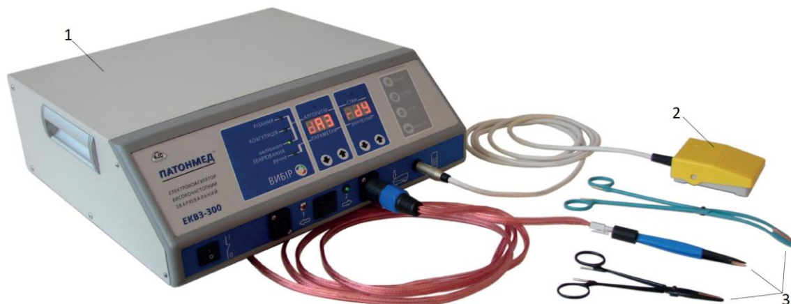
Figura 4. Aparelho multifuncional EKVZ-300 para soldagem de tecido vivo, onde: 1 - fonte, 2 - pedal ligar/deligar e 3 - “eletrodos” pinças e fórceps (adaptado de Patonmed, 2021)
