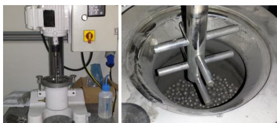
Figura 1. Moinho Atritor de alta energia com bolas de metal duro com capacidade de 3kg de misturas.
