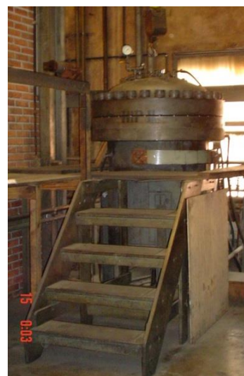
Figura 3 (a). Ciclo térmico de sinterização dos corpos de provas e (b) forno de sinterização HIP utilizado neste trabalho.
