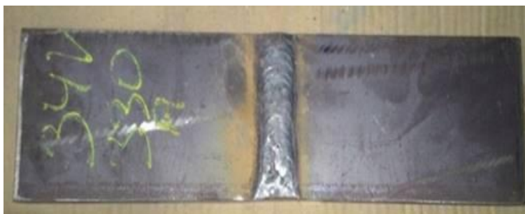
Figura 6. Junta soldada sob a “ Condição de Soldagem III ” – U_3 = 33 V, i_3 = 300 A e Polaridade DC.
