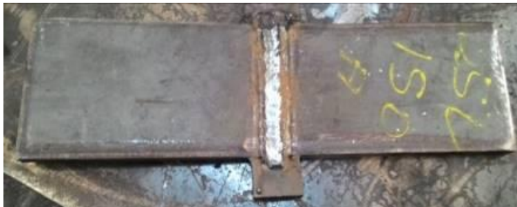
Figura 4. Junta soldada sob a “ Condição de Soldagem I ” – U_1 = 24 V, i_1 = 150 A e Polaridade DC.
