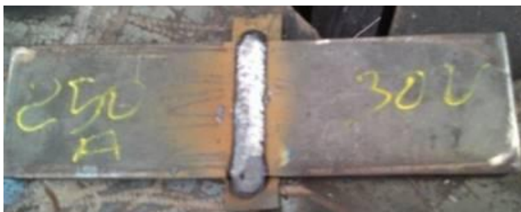
Figura 5. Junta soldada sob a “ Condição de Soldagem II ” – U_2 = 28 V, i_2 = 250 A e Polaridade DC.
