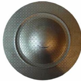
Figura 2 - Corpo de prova gravado com malha circular após a deformação (Lumelskyj, et al. 2015).
