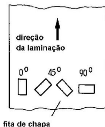
Figura 4 - Orientação de corte de corpos de prova para determinação da anisotropia (Lora, et al. 2009a).
