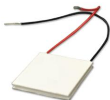
Figura 3: Pastilha Peltier usada no presente estudo. (Fonte: FlipFlop)
