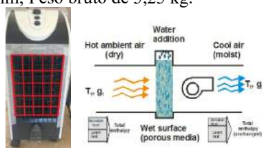
Figura 2: Climatizador utilizado (face frontal) e esquema de funcionamento (RED) (Boukhanouf et al., 2013).
