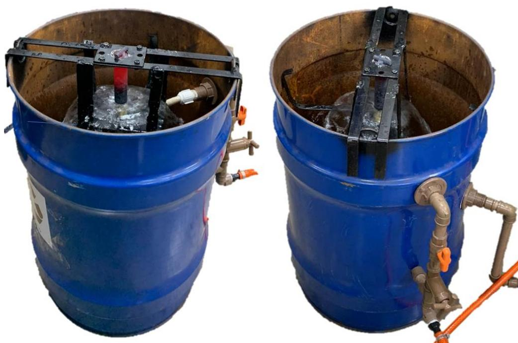
Figura 3. Amostra sendo submetida ao ensaio de temperabilidade no dispositivo Jominy, fabricado e montado no tambor de descarte (esq.); Detalhes da instalação dos canos de alimentação e de drenagem de água no dispositivo para ensaio Jominy (dir.) (Os autores, 2020)
