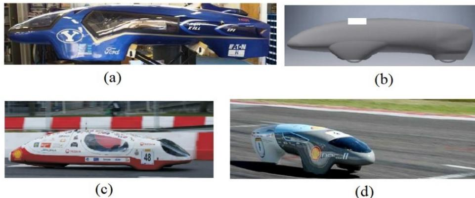
Figura 4. – Veículos que serviram de inspiração, com os valores de  $C_D$  sendo: (a) 0,107; (b) 0,13; (c) 0,096; (d) 0,075 ((a, c e d) (Such, 2018); (b) (Sirojuddin et al., 2019)).
