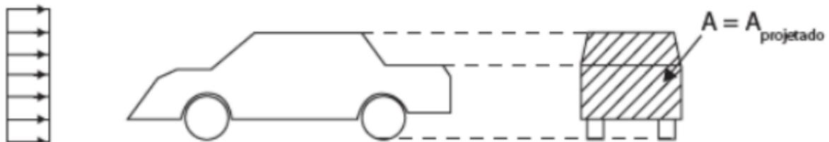
Figura 1. Exemplo de área projetada (Windlin et al., 2012, p. 256, modificado).
