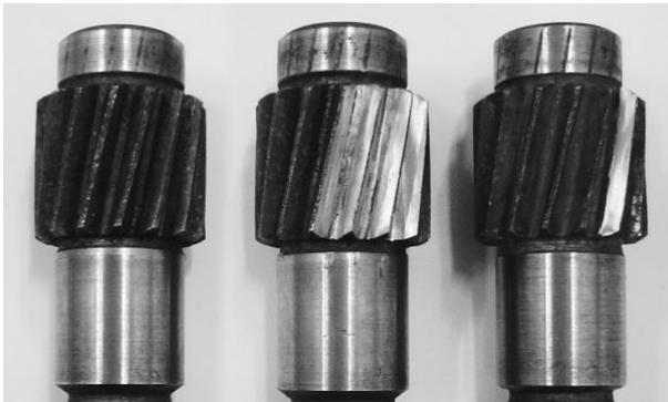
(a) Condições das engrenagens: (1) Engrenagem esquerda: Saudável (2) Engrenagem intermediária: Dentes desgastados (3) Engrenagem direita: Dente lascado [Figura extraída de (Zamanian and Ohadi, 2011)].
