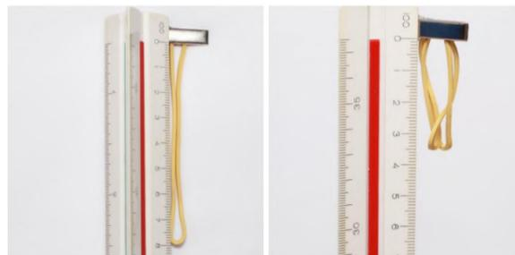
Figura 7. Ensaio 2 - Elástico de látex em duas configurações, utilizado em substituição à mola de tração helicoidal
