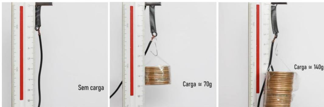
Figura 6. Ensaio 1 -Capacidade de atuação e recuperação da Mola de Nitinol ao ser energizada - Frames retirados dos vídeos do Ensaio
