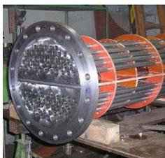
Figura 1. Trocador de Calor de Casca e Tubo
