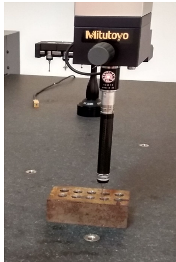
Figura 5. Corpo de prova usinado posicionado para medição (Autoria própria).
