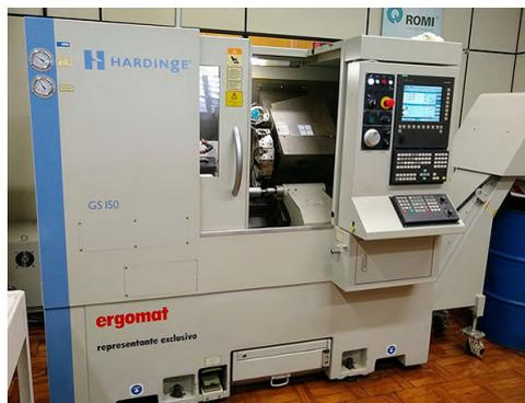
Figura 5. Torno CNC Hardinge GS 150 (Acervo dos autores)
