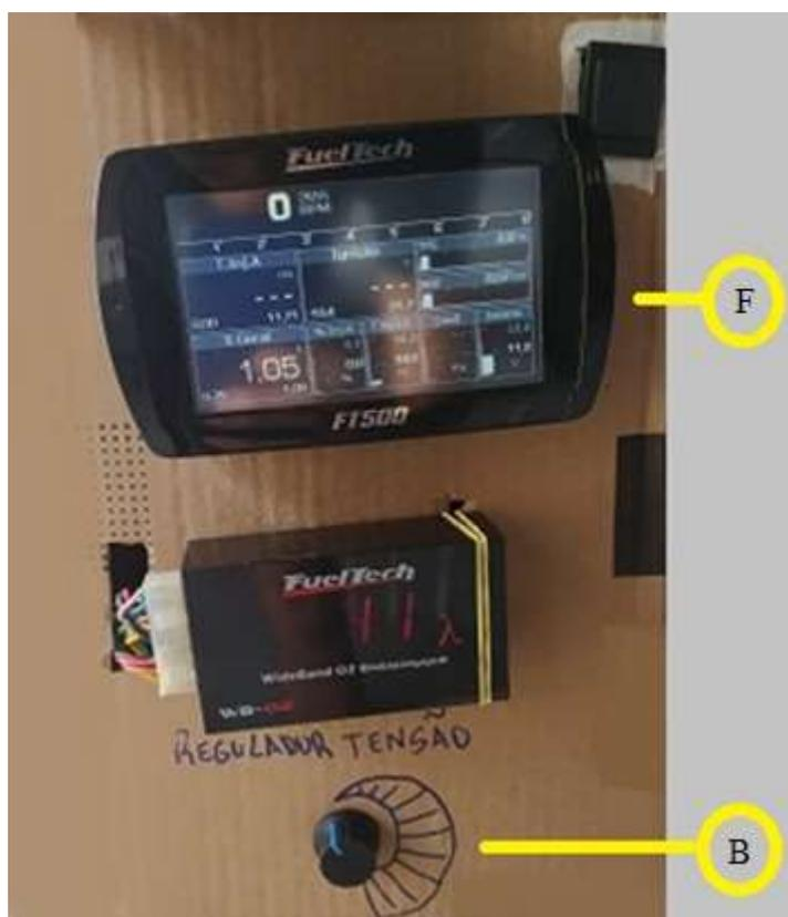
Figura 3. Painel de controle com módulo Fueltech-FT500 e regulador de tensão. (Fonte: autores).
