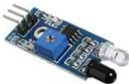
Figura 5. Sensor óptico reflexivo. (Fonte: Filipeflop, 2020).
