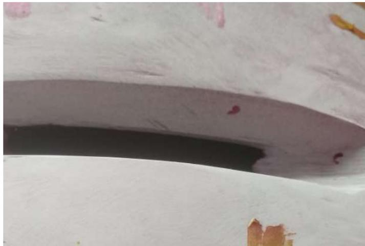
Depois de todo o procedimento de reparo descrito acima, a junta foi liberada para a soldagem e em seguida foi submetida a sequência de ensaios necessária, como: visual de solda, líquido penetrante, partícula magnética, e, por fim, o ultrassom.
