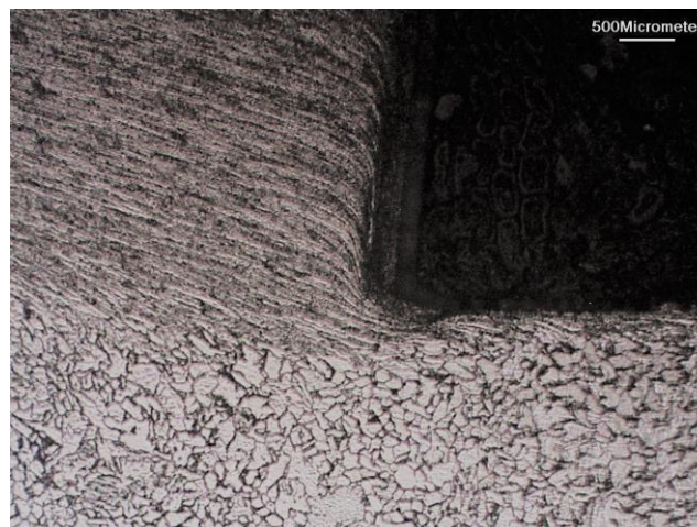
Figura 5. Micrografia da raiz do cavaco do Aço ABNT 1020, v_c = 60 m/min, f = 0,1 mm/rot.
