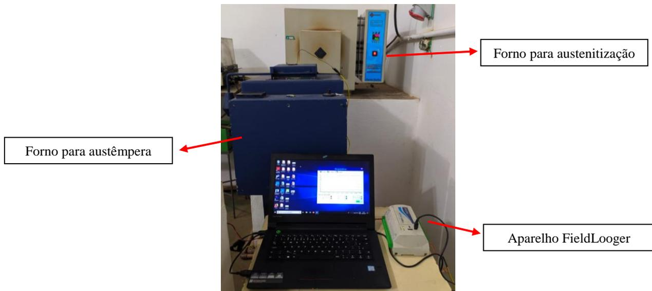
Quando as amostras foram imersas no banho de estanho, rapidamente a temperatura que era de 850°C se igualou à temperatura do banho, sendo mantidas por 1 hora para a transformação bainítica, conforme curva TTT do aço 4140 na Figura 3.
