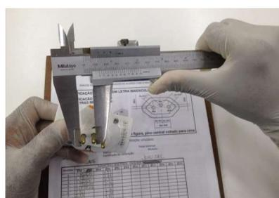
Figura 5a - Medição de diâmetro (Autor, 2017)
