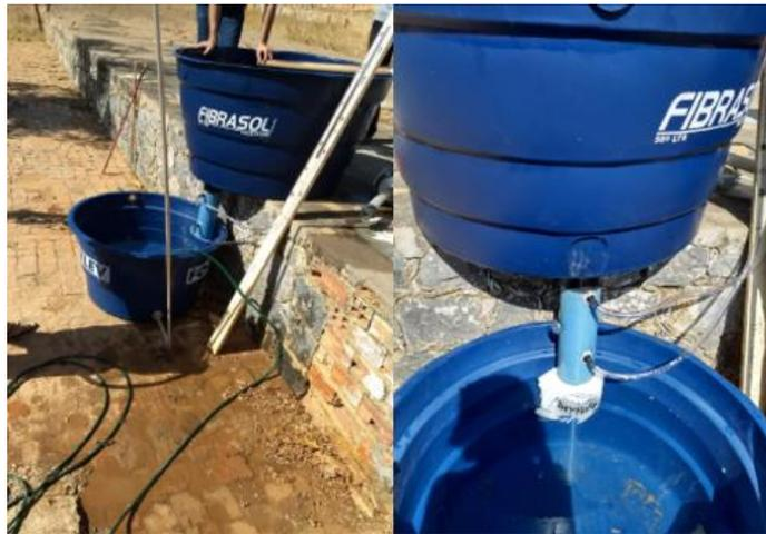
Para montagem do sistema furou-se o fundo da caixa d'água com um diâmetro de 100 mm de forma que comporte o cano que contém a turbina, Fig. 10. Para que fixar o cano no fundo da caixa serrou-se o cano e coalesceu-se a extremidade do material para que fosse possível dobrar uma pequena fração da tubulação formando um flange adaptada que possibilita fixação e evita vazamentos, como ilustra a Fig. 10.
