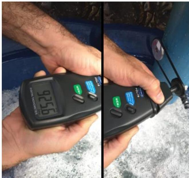
Como o preenchimento da caixa d'água foi realizado manualmente apenas foi alcançado um nível de 30 cm de altura de água, ainda assim o regime foi transiente já que não houve reposição de água gerando queda de pressão ao longo do procedimento. Para o nível de 30 cm conseguiu-se uma rotação de 925.6 rpm. Fazendo uma relação linear da coluna
