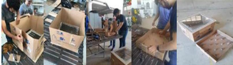
Na caixa menor, desejou-se que esta tivesse 10 cm a menos na largura como no comprimento em relação a caixa maior, deixando na montagem um espaço de 5 cm entre as duas. O interior da caixa menor foi revestido com papel alumínio e a base dela foi ocupada por uma placa metálica (ferro), a qual foi cortada no tamanho necessário e pintada com uma tinta preto fosco diante a Figura 8.
