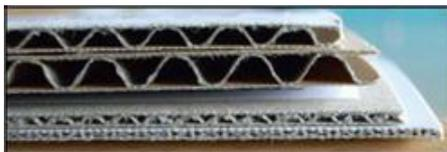
Além disso, várias características são atribuídas devido a essa estrutura do papelão, por exemplo, estas três camadas básicas de papel são montadas em uma maneira que dê à estrutura total uma resistência melhor do que aquela de cada camada distinta. Esta construção engenhosa dá forma, fixa as dimensões de uma série dos arcos conectados levando a não só a geometria ter maior resistência a flexão, tendo a rigidez e resistência consideráveis, mas até suporte pesos sobre sua superfície.
